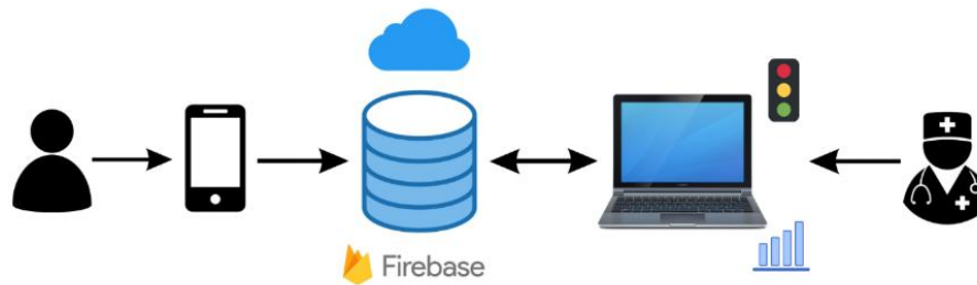
Figura 5: Esquema del funcionamiento de la aplicación HomeITB y su conexión con la base de datos.
