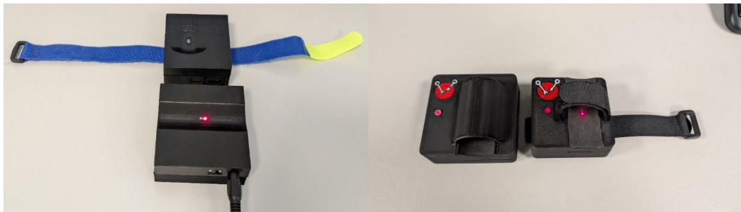
Figura 2: Comparativa entre el sistema HomeITB diseñado inicialmente, y el prototipo final de las carcasas de la mano y el pie. En la izquierda, el diseño anterior; en la derecha, el nuevo diseño de las cajas.
