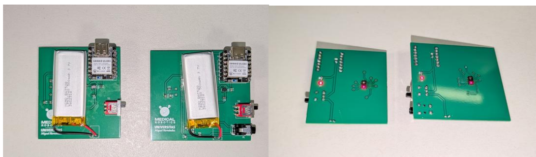
Figura 3: Rediseño de la electrónica. En la izquierda, la cara inferior; en la derecha, la cara superior con el sensor y el led.
