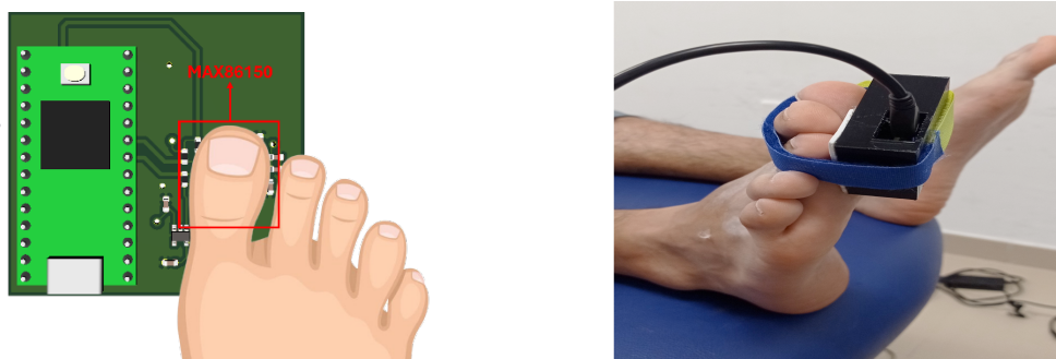
Figura 3: Conexión del equipo para el registro de la señal PPG en el dedo hallux del pie. A la izquierda, esquema de configuración; a la derecha, sujeción del equipo con cinta velcro.
