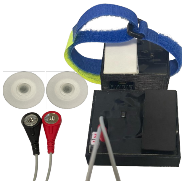
Figura 1: Dispositivos de medición del sistema HomeITB. En la parte superior, equipo para la captura de la señal PPG en el pie; en la parte inferior, equipo para el registro de señales ECG en el tórax y PPG en la mano.
