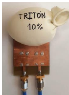
Fig. 3. Proceso de medida con material, en este caso con una proporción de Tritón X-100 del 10% y agua destilada del 90%.
